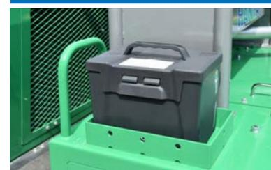
運転席両側に予備ビット置き場を設けました。作業中にビットが破損した場合でも、迅速に対応できます。
