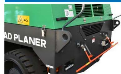
危険回避のため、機械前後に機能停止バー(ドラム・走行停止)を装備しています。
