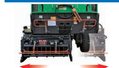
縁石一杯の切削、マンホール等の障害物を避けての作業、切削合わせの作業効率化に威力を発揮します。機械左側より外側150 mm、右端より外側に85 mmシフトします。
