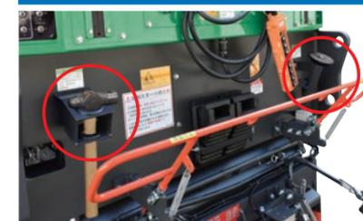
ビット交換の際、迅速に対応できるように機械後部にビット抜きとハンマーの収納場所を設けました。
