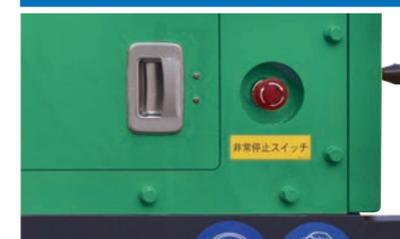
非常停止スイッチは運転席に1ヶ所、機械後部に2ヶ所(エンジン停止)を備えています。また、非常停止スイッチの解除方法を、従来のタイマー式から、回転式に変更しました。
