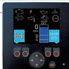
地上での操作がメインとなるオペレータが、作業中にエンジンコンディション等を確認できるよう機械後部の左側面に配置しました。
