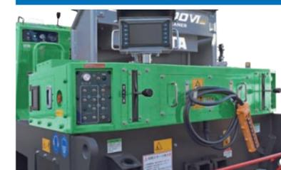
機械後部の左右に操作パネルと走行レバーを設置しました。左右どちらの位置からでも切替え操作の必要なく後操作優先で操作することが出来ます。
