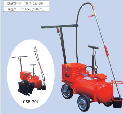
CSB-20は、バッテリーでコンプレッサを駆動し、その空気圧を利用してアスファルト乳剤を散布します。充電式バッテリーを使用しますので、必要に応じて充電可能です。また、CSB-20Jはジョイント散布装置付きにする事で切削工事の垂直面へのアスファルト乳剤散布に最適です。
