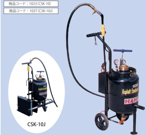
CSK-10は手押しポンプ式で、空気圧を利用して少量散布に適した手軽なタイプです。洗浄液タンクが付いたツインポンプ式で、ノズル目詰まり防止用洗浄装置付きです。また、CSK-10Jは、切削オーバーレイ時のジョイント垂直面へのアスファルト乳剤散布に最適です。
