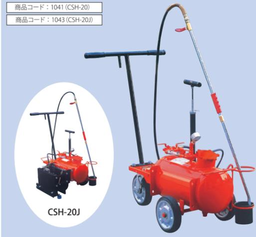
CSH-20は、エンジンを使用せず、手動ポンプで空気圧を利用してアスファルト乳剤を散布します。CSM-15Hによる散布よりさらに少量散布を必要とする現場に最適です。乳剤供給口が大きく、漏斗を必要としません。また、CSH-20Jはジョイント散布装置付きにする事で、切削工事の垂直面へのアスファルト乳剤散布に最適です。
