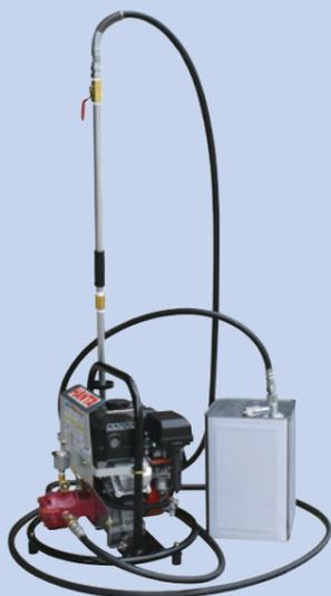
本機は一人で持ち運び可能な小規模散布に適した小型軽量なスプレヤです。1斗缶・ペール缶・ドラム缶等あらゆる容器から直接散布可能です。ポンプ及びリリーフ（内蔵式）はオイルカップ付きですのでワンタッチで瞬時に洗浄でき、吸入不能に対応できます。本体は共通で台車式又はジョイント散布装置付きにすることができます。
