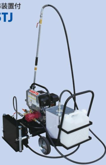
本機はCSM-15Tにジョイント散布装置を装着したもので、切削オーバーレイ時のジョイント垂直面へのアスファルト乳剤散布、及びアスカーバ施工時等のライン状散布(高さ及び幅調整可能)に使用できます。又、一本撒きも可能です。前輪は自在式で、後輪は固定式で2輪です。
