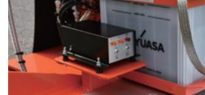
油圧レシプロ機構の油圧シリンダをコントロールするボックスです。スイッチにて成形の大小、使用条件に合わせてシリンダストロークをタイマーにて調整できます。
