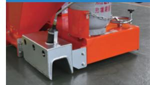
LPバーナにて成形枠を加熱することにより、抵抗を著しく減少させることができ、成形仕上りにも好結果が得られ、下図の様な各種のものが取付けることが出来ます。
