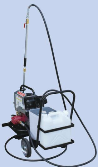
本機はCSM-15Hに台車を装着し、1斗缶又はペール缶及び洗浄容器(10ℓ)をセットできます。1斗缶又はペール缶から直接散布可能です。前輪は自在式で、後輪は固定式で2輪です。
