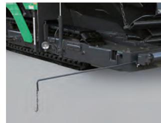
走行指針照明灯
